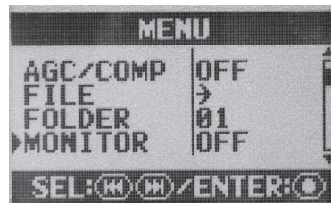
[2-15] メニュー画面を開き「MONITOR」を選択してRECキーを押す
