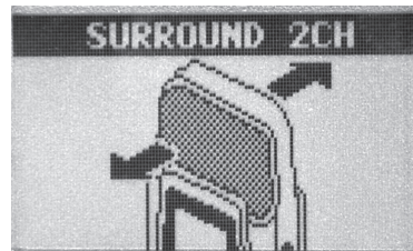
[2-12] サラウンド2chグラフィック 前後マイクを同時に使用してステレオ収録するSURROUND 2CH
