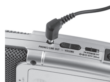
[2-14] ヘッドホンを繋げば、録音待機または録音中にヘッドホンモニタできる
