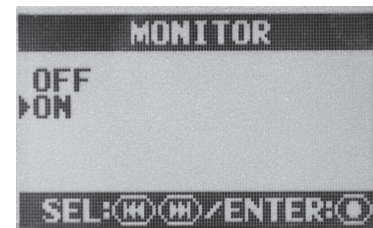
[2-16] ONを選択すれば、H2が停止状態でも常にモニタ可能となる
