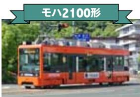
超低床車としては世界初の単車。2002年に登場したリトルダンサーシリーズで、伊予鉄初のVVVFインバータ制御車。
