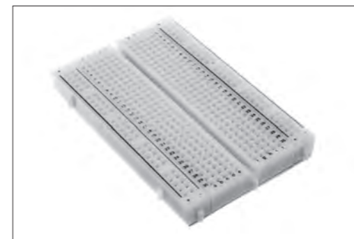
■図8-2: よく見かけるタイプのブレッドボード
