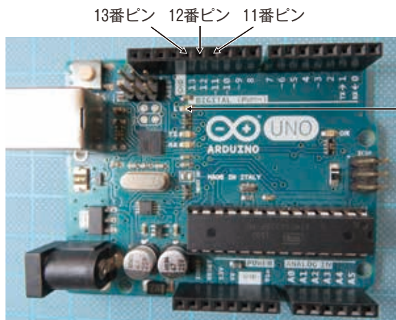
図1-1 Arduino UNOにはデジタル入出力できるピンが0番から13番まである(この他、A0~A5も利用できる)。
