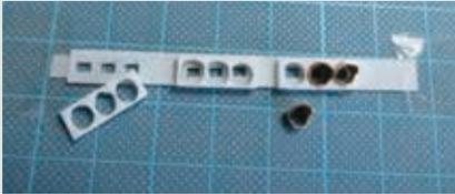
**図 1-26** ポールの材料 (3 本分)。写真左 3 本が支柱になる長さ 100mm × 外径 2mm の細密パイプ、その右隣は、上から支持棒になる 0.3mm の真鍮線、ポールから突き出す腕になる外径 1.2mm の細密パイプ、それを支える直径 0.6mm の真鍮線。支柱の道路面からの高さは 94mm、道路と接する部分には厚さ 0.2mm × 幅 2mm の帯材を巻いた。
