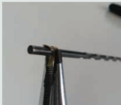
の太さです。これを1本ずつ、信号板の腕になる内径1mm(外径1.2mm)の細密パイプの中を通し、さらに支柱になる内径1.8mm(外径2mm)の細密パイプの中を通します。
