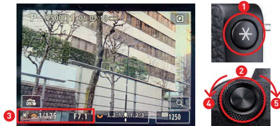
AEロックボタンを押す①。メイン電子ダイヤル②を回すと、メーターが表示されるので③、メイン電子ダイヤルを左右に回して絞り値とシャッター速度の組み合わせを選ぶ。④のほうに回すと絞り値が大きくなり、⑤のほうに回すと絞り値が小さくなる。
