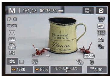
AF方式を顔+追尾優先AFに設定しているとき、被写体をタッチすると、AFフレームがその被写体を認識し続ける。もしも被写体が画角から外れてしまっても、また画角内に戻せば認識し直してくれる。
