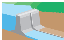
①重力式 コンクリートダム
