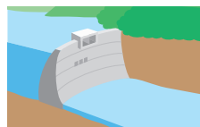
②アーチ式 コンクリートダム
