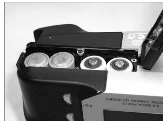
↑QV-3000EXの電池蓋のツメは内側にあり破損し難い
