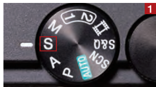
モードダイヤルをS(シャッタースピードAE)に合わせる。
