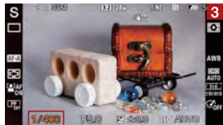
コントロールダイヤルを回すとシャッタースピードが変更され、絞り値はシャッタースピードに合わせて自動で設定される。
