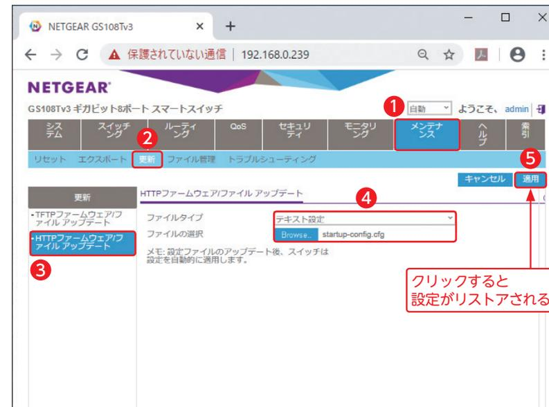
「ファイルタイプ」でテキスト設定を選択し、「ファイルの選択」でBrowseをクリックしたら、パソコンに保存しているファイルを選択します④。「適用」をクリックすると⑤、設定がリストアされます。
