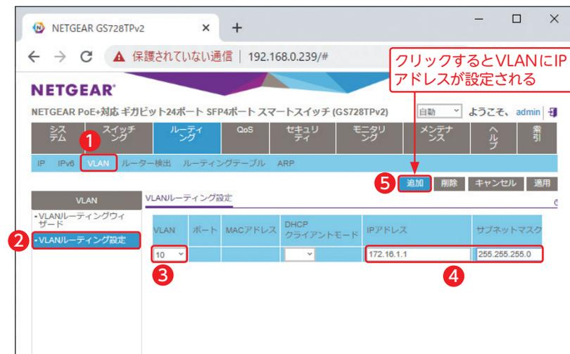
設定するVLANを選択し③、IPアドレスとサブネットマスクを入力し④、「追加」をクリックすると⑤、VLANにIPアドレスが設定されます。この画面の例では、VLAN:10を選択してIPアドレス172.16.1.1、サブネットマスク255.255.255.0を入力しているため、172.16.1.0のサブネットが作られます。
