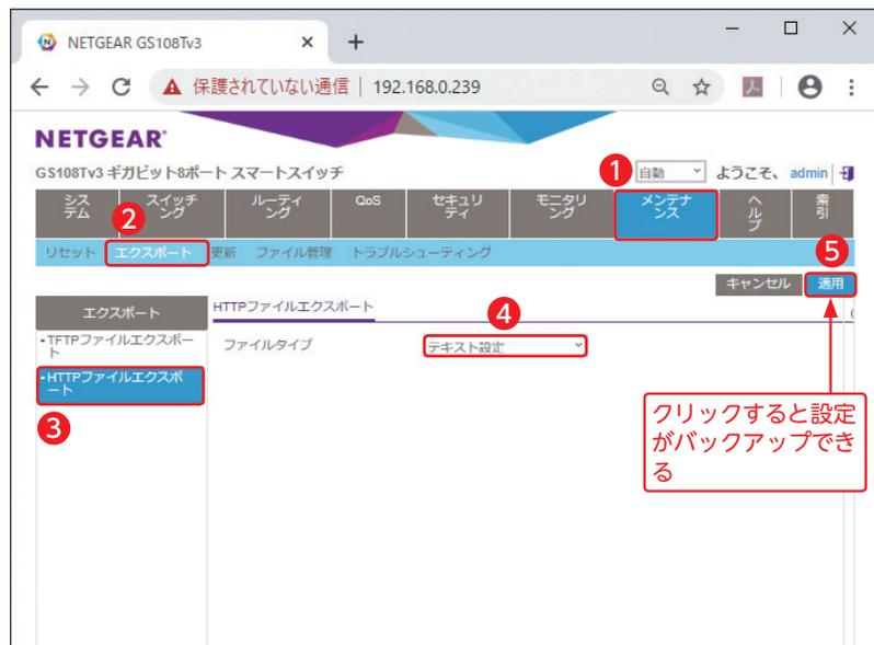
「ファイルタイプ」でテキスト設定を選択し④、「適用」をクリックすると⑤、設定内容がパソコンにバックアップされます。
