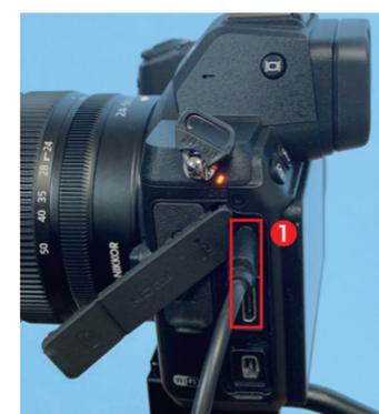
Z5はUSB給電ができるので、モバイルバッテリーを接続して①、USB給電を行いながら撮影します。
