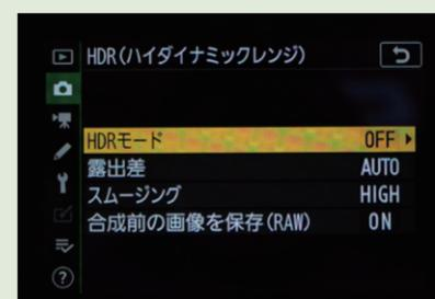
HDRタイムラプスの場合、カメラ内のHDR機能は使用しません。この機能はカメラ内で合成作業まで行うため、撮影間隔が長くなり、タイムラプスにした時にカクカクとした動画になってしまいます。また、RAWファイルでの記録ができずJPEGのみになるため、Lightroomによる補正ができないこともデメリットです。
