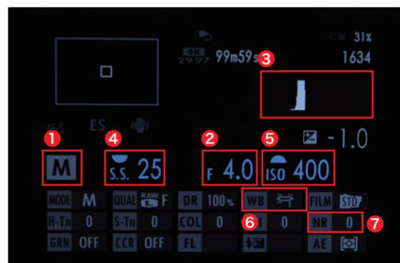
まずはカメラ側の撮影設定を整えます。露出モードをマニュアルに設定し①、絞りを開放よりやや絞り気味で固定します②。ヒストグラムを見ながら③、適正露出になるようにシャッター速度④とISO感度⑥を設定します。また、ホワイトバランスは必ずオート以外に設定して固定します⑥。ノイズリダクションはOFFにします⑦。
