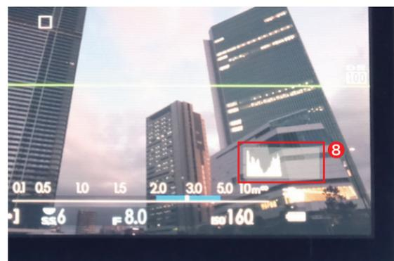
次に、外部機器を使ってインターバルタイマー撮影を開始します。撮影進行中も、カメラの画面には常にヒストグラムを表示しておきます⑧。時間が経ち日が沈むと周囲は暗くなり、ヒストグラムも左に寄ってきます。少し左に寄ったタイミングでシャッター速度を遅くし、ヒストグラムがなるべく一定の形を保てるようにします。シャッター速度の下限は、カメラのノイズリダクションの性能によりますが、星まで写すホーリーグレイルの場合は30秒程度、夜景のみなら5秒程度です。シャッター速度が下限に達したらISO感度を上げて、同じようにヒストグラムを同じ形に保ちます。ISO感度の上限は6400程度までなら許容範囲でしょう。これを撮影終了まで続けます。
