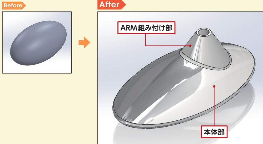
ここでは、基本的なスケッチ (楕円・直線・円コマンドなど) や、フィーチャー (回転・押し出しカット・参照平面・フィレットなど) を用いて MOBILE FAN の BASE を作成します。
