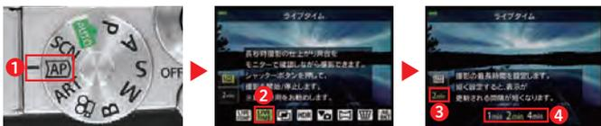
モードダイヤル①をAPに合わせるとアドバンスフォトモードになり、APモードメニューが表示される。◀▶でモード②を選択し、OKボタンで決定する。いくつかのモードはOKボタンを押す前に▽を押すと詳細な設定③ができる。◀▶で設定④を選択し、OKボタンで決定する。APモードの別のモードに変更したいときは、撮影待機状態で⏏(ショートカット)ボタンを押してAPモードメニューを表示する。
