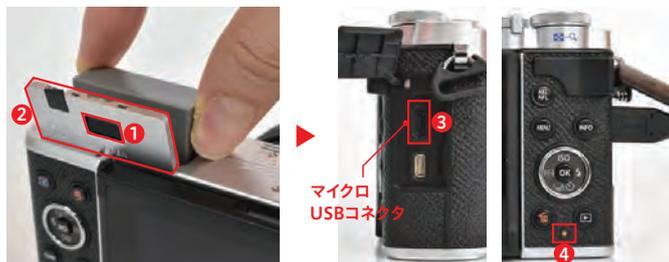
電池はカメラに入れて充電する。電源をオフにし、電池/カードカバーロック①を外して電池/カードカバー②を開く。カバー裏にあるイラストに合わせて電池を入れ、電池/カードカバーを閉める。USBケーブルの一方をカメラのマイクロUSBコネクタ③に、もう一方とUSB-ACアダプターを繋いでコンセントに接続する。充電中はCHAR GEランプ④が点灯し、充電が完了すると消灯する。
