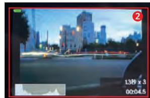
シャッターボタンを全押しするとノイズリダクション用の画像を取得し、自動的に撮影を開始する。一定時間ごとに合成された画像がモニターに表示される②ので、適度な明るさになったら再度シャッターボタンを押して撮影を終了する。
