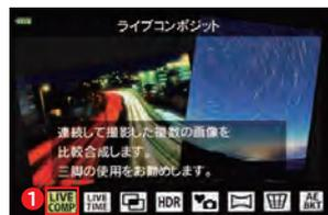
モードダイヤルをAPに合わせる。◀▶で[ライブコンポジット]を選択し①、OKボタンで決定する。
