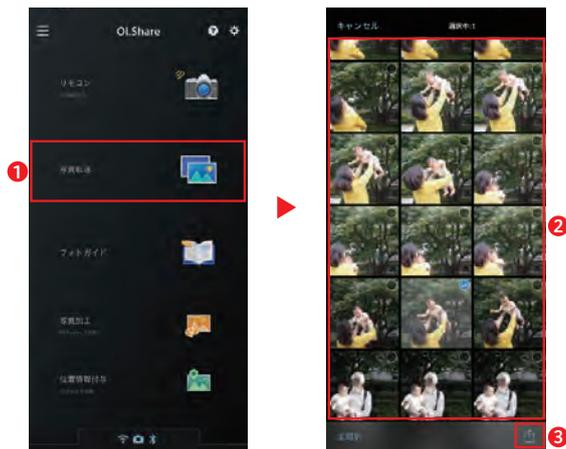
スマートフォンでOI.Shareを起動して、E-P7と接続したら、[写真転送]①をタップする。カメラ内に保存された画像が一覧となって表示される②。スマートフォンで転送するには、写真の右上の○をタップして選び、右下に表示される■をタップする③。[取り込み]と[シェア]の選択画面が表示されるので、実行したいほうをタップする。
