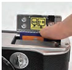
使用できる記録メディアはSD規格の市販のSD、SDHC、SDXCカード。電池をセットするときと同様に電池/カードカバーを開け、向きに注意してカードをロックされるまで差し込む。抜くときは、カードを軽く押すとロックが外れて出てくる。はじめて使うカードは初期化を行う。
