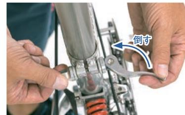
3 レバーを倒してサドルを固定。固定されないときはレバーを起こした状態でナットを締めてからレバーを倒す。
