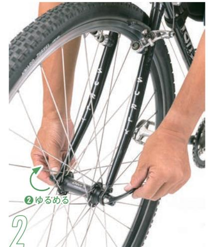
2 クイックリリースレバーを自転車の外側に起こすと、瞬時に締め付けがゆるむ。レバーを持ったまま、反対側のナットを回してゆるめる。
