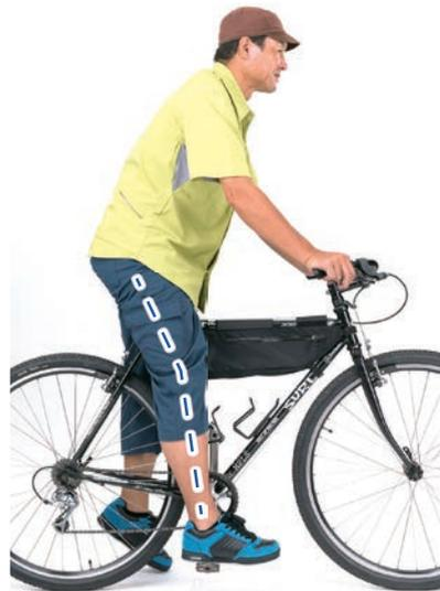
スムーズなペダリングの第一歩はサドルの高さ調整から。ペダルを一番低い位置にして踵を載せ、ヒザが軽く曲がる程度に調整。
