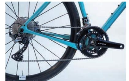
荷物を積んで長距離を走るような用途には、変速域が広く、きめ細かなギア比を選べるフロント変速機搭載のコンポーネントを選んだほうが快適だ。
