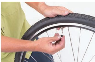
**20** バルブのネジをきちんと締め、最後にキャップをつければ完了。
