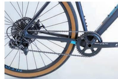
リアスプロケットの大型化により、フロント変速機がなくても上り坂で困らない軽いギアを実現したモデルも増えている。見た目もシンプル。
