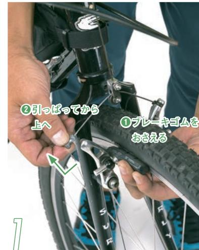
1 前輪を外す前に、ブレーキのゴムの間隔を広げてタイヤを抜けるように準備する。写真のカンチブレーキはワイヤーを手で外す。
