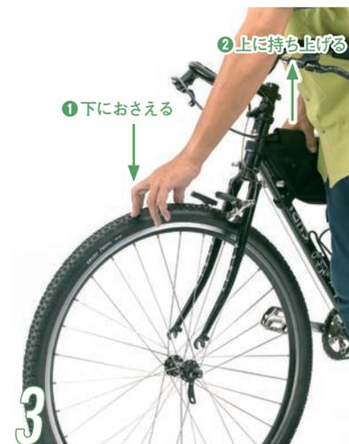
3 ある程度、ナットをゆるめたら、前輪をおさえながらフレームを持ち上げれば取り外せる。取り付けは、この逆の手順で行なう。
