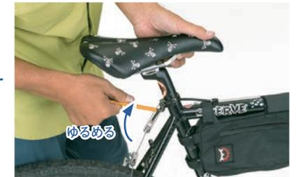
1' ボルト締めの場合には、アーレンキーを使って固定ボルトをゆるめる。
