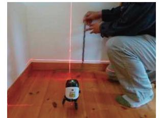
「床の傾きを計測する」調査機器
