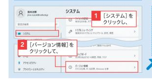
自分のパソコンで動作しているWindows のエディ ションとバージョンは、スタートメニュー (44ページ 参照)の[設定]♥→[システム]→[バージョン情報] をクリックすると確認できます。「設定」アプリでメ ニューが表示されていない場合は、ウィンドウの左上 にある[ナビゲーションを開く] ■をクリックします。
