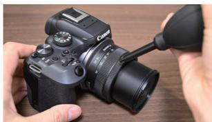
メンテナンスに欠かせない道具がブローヤ。シリコン部分を握ることで空気を噴出し、ホコリを飛ばす。ただし勢いよく握りすぎると、風圧が強くなりカメラを傷つけてしまうので、優しく噴射しよう。
