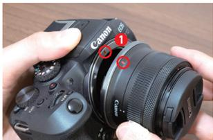
カメラとレンズのキャップを外し、RFレンズ取り付け指標を合わせながら**1**、レンズをはめ込む。
