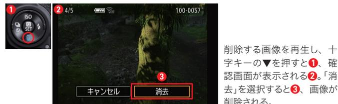
削除する画像を再生し、十字キーの▼を押すと**1**、確認画面が表示される**2**。「消去」を選択すると**3**、画像が削除される。
