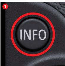
表示内容の変更は、カメラ背面のインフォボタンを押すだけだ<sup>①</sup>。R10のファインダーの表示形式は3種類ある。使いやすい表示を選ぼう。
