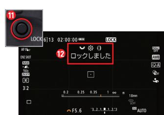
マルチ電子ロックボタンを押すと⑪、サブ電子ダイヤル、マルチコントロール、コントロールリングの設定をロックできる⑫。
