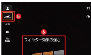
クイック設定画面に戻り、「フィルター効果の強さ」にカーソルを合わせ⑤、◀▶またはメイン電子ダイヤルを回して、効果の度合いを設定する⑥。
