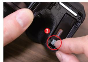
バッテリーを取り外すときは、ツメをずらすと**3**、バッテリーが飛び出してくる。
