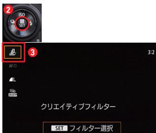
クイック設定ボタンを押して②、クイック設定を表示し、「クリエイティブフィルター」を選択する③。
