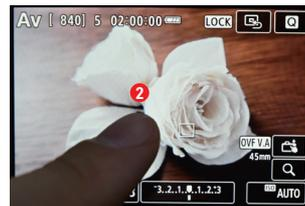
モニター上でピントを合わせたい被写体をタッチすると**2**、AFが作動してピントが合い、シャッターが切られる。
