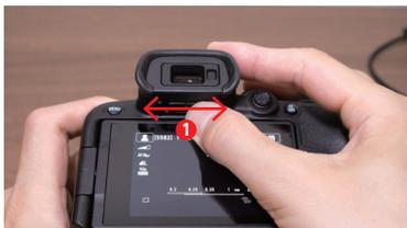
ファインダー下にある視度調整レバーを左右に動かし①、視度調整を行う。ファインダーを覗きながら、もっともはっきり見えるところに調整しよう。
