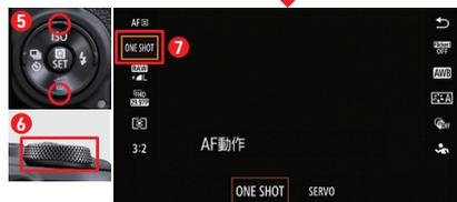
十字キーの▲▼を押すか**5**、サブ電子ダイヤルを回して**6**、設定項目を選択する**7**。
