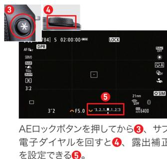
AEロックボタンを押してから③、サブ電子ダイヤルを回すと④、露出補正を設定できる⑤。
