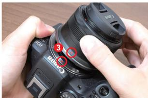
RFレンズ取り付け指標が合うところまで回し**3**、レンズを取り外す。取り外した後は、カメラとレンズにキャップを取り付ける。
