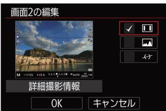
「ファインダー情報表示カスタマイズ」を選択した後にインフォボタンを押すと、ファインダー内に表示する項目を変更することができる。「詳細撮影情報」「ヒストグラム」「水準器」の3項目から選択する。
