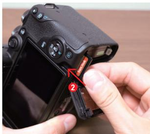
向きに気をつけながらSDカードを差し込む②。「カチッ」と音が鳴れば挿入完了だ。挿入が完了したらカード/バッテリー収納部ふたを閉める。
