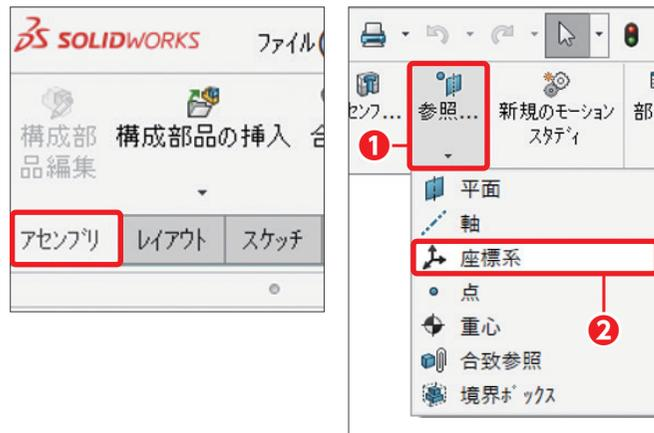
2 CommandManager「アセンブリ」の [参照ジオメトリ] をクリックして展開し ①、 [座標系] をクリックします ②。
