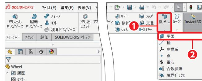
1 基準面と距離を指定して参照平面を作成します。Command Manager「フィーチャー」の「参照ジオメトリ」をクリックして展開し①、[平面]をクリックします②。
