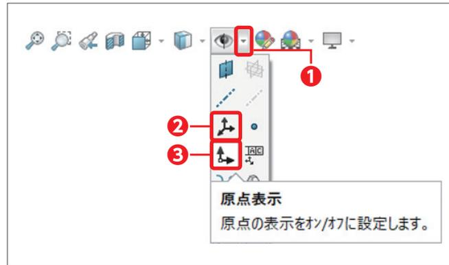
1 ヘッドアップビューツールバーの [全タイプを非表示] 横の [▼] をクリックし ①、 [座標系表示] ② と [原点表示] ③ をクリックしてオンにします。
