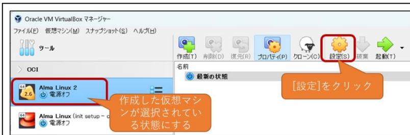
1. VirtualBox マネージャーで、作成した仮想マシンが選択されている状態で、[設定]をクリックします。
