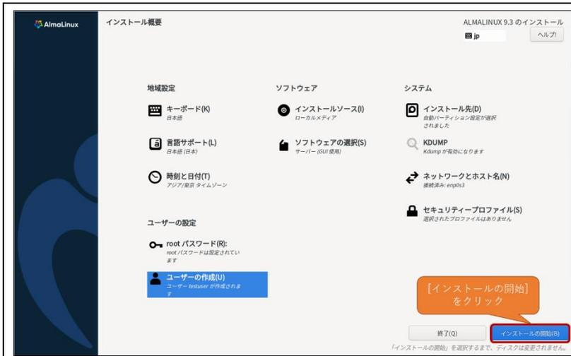
13. 必要最低限の設定が完了しましたので、[インストールの開始]をクリックします。
