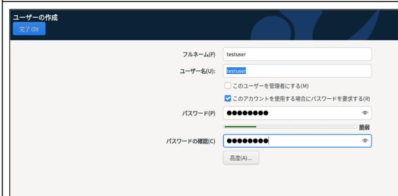
12. インストールの概要画面に戻り、[ユーザーの作成]をクリックします。左図のような画面が表示されますので、フルネームおよびユーザー名に **testuser** と入力し、使用するパスワードを入力します。付属の環境と同じパスワードにする場合は **testpass** と入力します。
