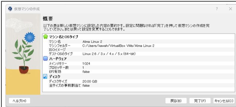
5. ここまで選択した内容の概要が表示されますので、確認した上で、[完了]をクリックします。
