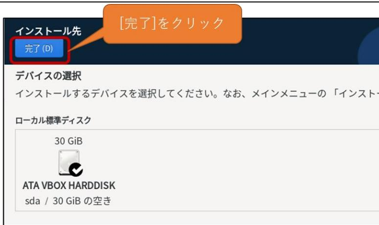
9. 左図のように認識している仮想ディスクが表示されますので、[完了]をクリックします。
