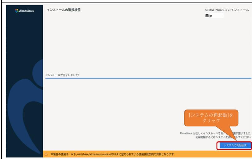
14. しばらく待つと、インストールが完了します。ので、[再起動]をクリックします。
