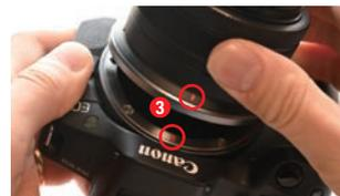
RFレンズ取り付け指標が合うところまで回し**3**、レンズを取り外す。取り外した後は、カメラとレンズにキャップを取り付ける。
