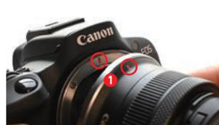
カメラとレンズのキャップを外し、RFレンズ取り付け指標を合わせながら**1**、レンズをはめ込む。
