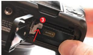
バッテリーを取り外す時は、ツメをずらすと**3**、バッテリーが飛び出してくる。
