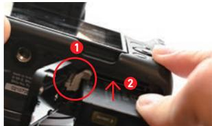
カード/バッテリー収納部のふたを開け、ツメを避けながら**1**、バッテリーを奥まで差し込む**2**。
