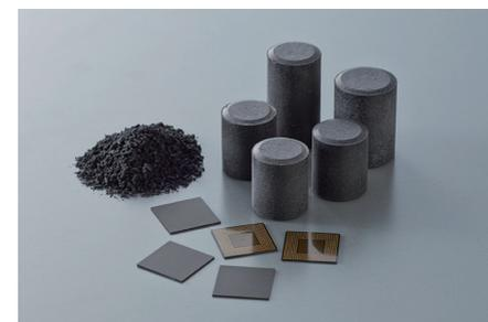
半導体封止用エポキシ樹脂成形材料「スミコン® EME」。環境対応型として、フロム系およびアンチモン系の難燃剤を使用せず、難燃性規格 UL-94 V-0 を達成している
