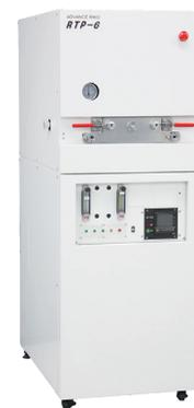
赤外線ランプ加熱装置 出所：アドバンス理工
