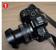
カメラの電源を入れ、沈胴式のレンズを装着している場合はレンズを繰り出しておく①。
