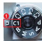
登録した設定を呼び出して撮影するには、**□/S&Q**ダイヤルを**□**に合わせたあと、モードダイヤルを回す。
