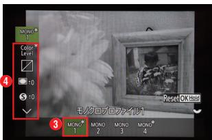
△▽でプロファイルを選択する③。さらに△▽で設定する項目を切り替えて、選択したプロファイルをベースに詳細を設定できる④。
