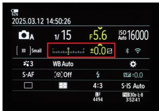
露出とはかんたんに言うと、写真に取り込む光の量、つまり明るさのこと。ISO感度（→P.48）、シャッター速度、絞り値の組み合わせで決まる。暗い場所では絞り値を小さく、あるいはシャッター速度を遅く、明るい場所では絞り値を大きく、あるいはシャッター速度を速くする必要がある。写真の明暗が撮影者の意図する明るさで再現された状態を、適正露出と呼ぶ。P、A、Sモードでは、カメラが被写体の明るさを見極めて露出を自動決定するが、画像がより明るく（プラス補正）、または暗く（マイナス補正）なるように撮影者が露出をコントロールすることができる。これを露出補正という。
