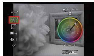
モノクロの画像にカラーfiltrerの効果をつける。8つの色をそれぞれ3段階の強度から選択する。カラーフィルターの色をフロントダイヤルから選び、強度はリアダイヤルで設定する。
