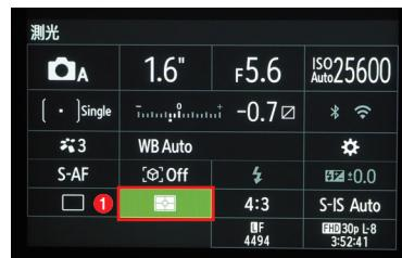
OKボタンを押し、モニターにLVスパークコンパネが表示された状態で△▽□ボタンで【測光】①を選択。フロントダイヤルを回し、種類を選ぶ。
