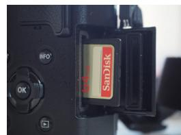
使用できる記録メディアは、市販のSD、SDHC、SDXCカード。電源をOFFにしてカードカバーを開け、向きに注意してカードスロットに、カードがロックされるまで差し込む。取り出すときは軽く押すとロックが外れて出てくる。
