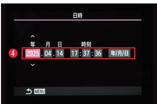
電源を入れたらMENUボタンを押し、[1] ①の[6.リセット/日時/言語/その他]②から[日時設定]を選択する③。[日時]を選択しOKボタンを押す。△▽◀▶で日付や時刻を設定する④。設定が終わったらOKボタンで確定する。
