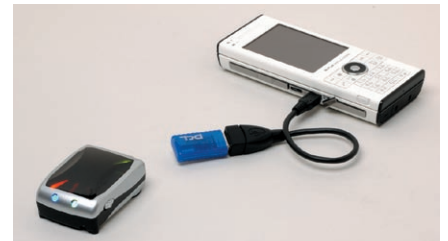
Bluetoothを使えるようにすればGPSもワイヤレスで使える
