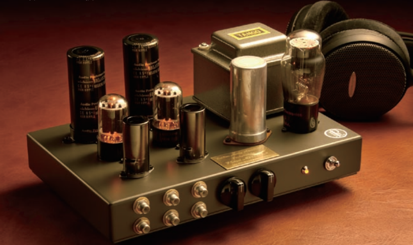
6BX7管とECC84を使ったOTLヘッドホンアンプ
