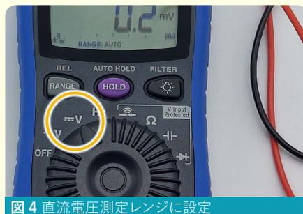
図4 直流電圧測定レンジに設定
