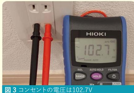
図3 コンセントの電圧は102.7V
