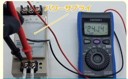
図5 パワーサプライの直流電圧は24.14V
